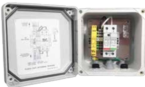
El gabinete de protección contra sobretensiones de la tecnología Flash (OVP) protege los sistemas de iluminación de la turbina eólica de sobretensiones y sobretensiones. El gabinete contiene circuitos de protección tanto para el cableado de alarma de baja tensión como para la potencia entrante.
